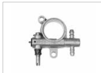
Bomba de aceite realizada en aluminio y regulable: permite variar el caudal de aceite en función del uso de la máquina y de la combinación de espada y cadena. El caudal nulo de aceite con el motor al mínimo asegura menor consumo y mayor protección del ambiente.
