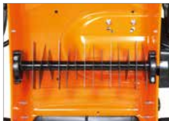
Rotor comprenant 15 couteaux fixes.
