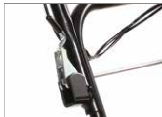
Un levier latéral permet de replier le guidon sur le carter et de gagner de l'espace pour le remisage.
