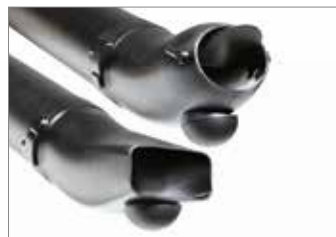
Deux embouts de sortie d'air de série : à section rectangulaire ou circulaire, tous deux dotés d'une demi-sphère pour la pose au sol sur terrains plats afin d'éviter la fatigue musculaire de l'utilisateur (SA 9010).
