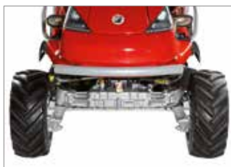
La bande de roulement de grandes dimensions et le centre de gravité abaissé assurent une stabilité optimale même sur terrains accidentés ou à proximité de cours d'eau ou de fossés.
