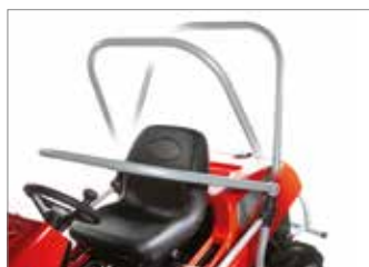
Équipées de série d'une rollbar, de pare-chocs avant et arrière, de protections latérales et de ceintures de sécurité pour une protection complète durant les situations les plus critiques.
