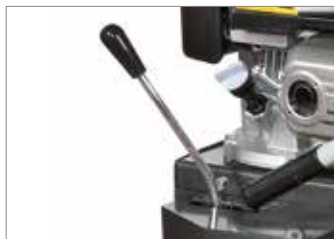
Commande sélecteur des vitesses avec levier.
