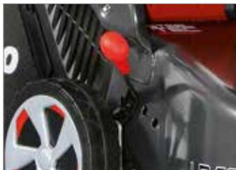
Sistema de regulação da altura de corte, acionável através de uma cómoda alavanca.
