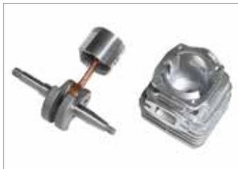
Pistão de 2 segmentos elásticos, cambota e biela em aço forjado e trabalhado, rolamentos de agulhas, cilindro revestido a níquel: asseguram um rendimento constante ao longo do tempo, mesmo no caso de utilização exigente.
