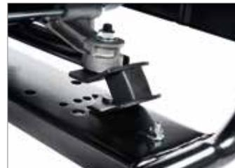
Motor colocado sobre elementos antivibratórios de borracha para reduzir ao mínimo as vibrações durante o funcionamento.
