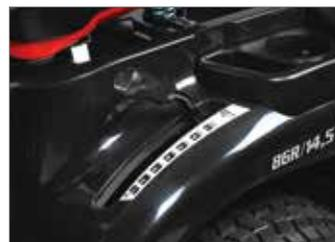
Regulação da altura de corte através de uma prática alavanca colocada à mão, com uma escala graduada que permite uma visualização imediata do nível de altura de corte desejado.
