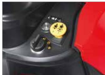
As lâminas são acionadas pelo operador premindo simplesmente o botão de comando da embraiagem eletromagnética situado no painel de instrumentos. Este sistema garante ativações das lâminas sem contragolpes.
