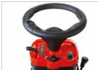
O engate da embraiagem eletromagnética ocorre rapidamente e de modo silencioso através de um cómodo botão situado no painel de comandos.
