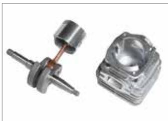
Pistão de 2 segmentos elásticos, cambota e biela em aço forjado e trabalhado, rolamentos de agulhas, cilindro com reforço em níquel: asseguram um rendimento constante ao longo do tempo, mesmo em caso de utilização exigente.
