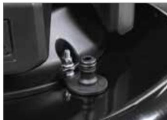
O conector rápido, "Deck Wash System", situado diretamente no prato de corte, permite conduzir a água diretamente para o interior facilitando, assim, as operações de limpeza do acessório de corte.
