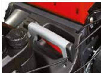
Dispositivo de regulação da altura de corte centralizado, comandado através de um punho robusto e ergonómico: permite regular a altura de corte para 5 posições, com simplicidade e sem esforço, segundo alturas compreendidas entre 28 e 75 mm.
