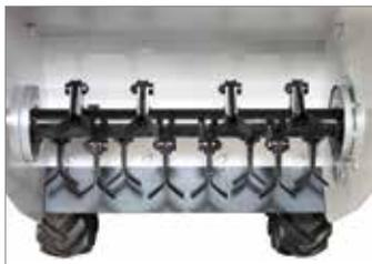
Rotor do grupo de corte suportado por rolamentos reforçados e blindados, torna toda a máquina perfeitamente equilibrada e resistente aos choques acidentais.
