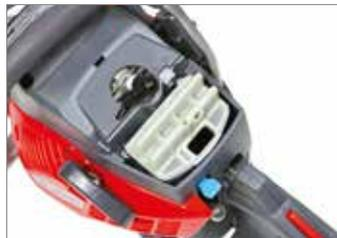
Filtro de nylon: graças a uma elevada superfície de filtragem, aumenta as horas de autonomia de trabalho entre uma limpeza do filtro e a seguinte.
