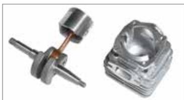
Pistão de 2 segmentos elásticos, cambota e biela em aço forjado e trabalhado, rolamentos de agulhas, cilindro revestido a níquel: asseguram um rendimento constante ao longo do tempo, mesmo no caso de utilização exigente.
