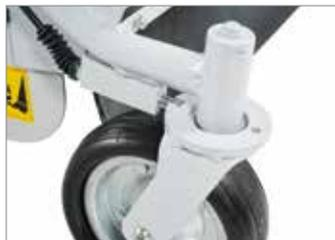
Rodas dianteiras pivotantes, bloqueáveis a partir da posição de condução (modelo **100, 100 TR**).
