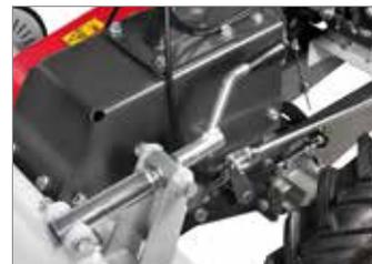
Regulação da altura de corte através de parafuso sem-fim. Regulável de 20 a 80 mm.
