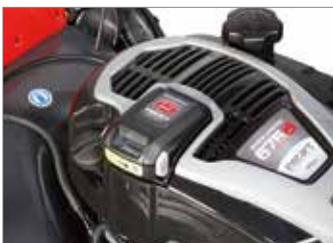
Os modelos **TBXE**, com motor Briggs & Stratton com arranque elétrico com bateria recarregável, asseguram um arranque facilitado.
