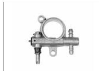
Bomba de óleo em alumínio regulável: facilita o trabalho do operador permitindo variar o fluxo do óleo em função da utilização da máquina e do acoplamento barra/corrente. O fluxo nulo do óleo com o motor em ralenti assegura um menor consumo e uma maior proteção do meio ambiente.
