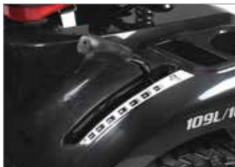
Prática alavanca de regulação da altura de corte ao alcance da mão, com escala graduada que permite uma visualização imediata do nível de altura de corte pretendido em 7 posições.
