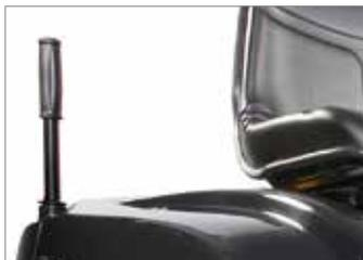
Alavanca telescópica de esvaziamento do saco facilmente alcançável a partir do posto de condução, permite o basculamento e o esvaziamento do saco cheio sem nenhum esforço muscular e sem torsões do busto.
