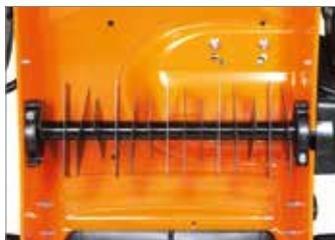
Rotor composto por 15 lâminas fixas.
