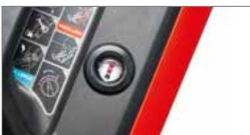
Indicador de nível de combustível em posição visível para permitir uma leitura rápida do nível de gasolina no depósito.
