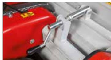
Altura de corte facilmente regulável através da alavanca de parafuso sem fim.
