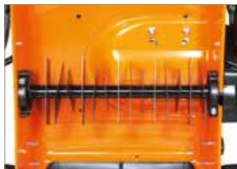
Ротор, состоящий из 15 стационарных ножей.
