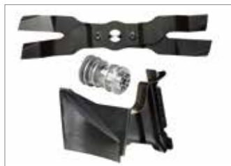
Kit mulching en option : l'herbe est coupée en particules très fines qui se déposent à la base du tapis d'herbe pour donner à la pelouse une coupe nette et toujours uniforme (lame + moyeu porte-lame + bouchon).
