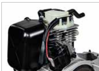
Moteur 4-temps avec distribution par soupape en tête (OHV).
