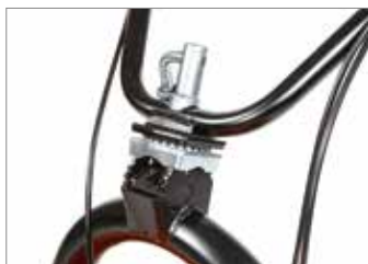
Guidon à réglage vertical et horizontal par levier.
