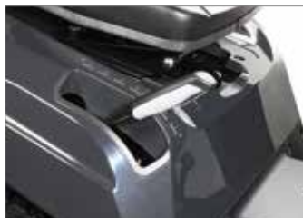
Réglage de la hauteur de coupe par un levier à portée de main et doté d'une échelle graduée qui permet de visualiser immédiatement le niveau de la hauteur de coupe souhaitée.
