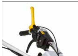
Levier de sélection des vitesses sur le guidon, facile à actionner.
